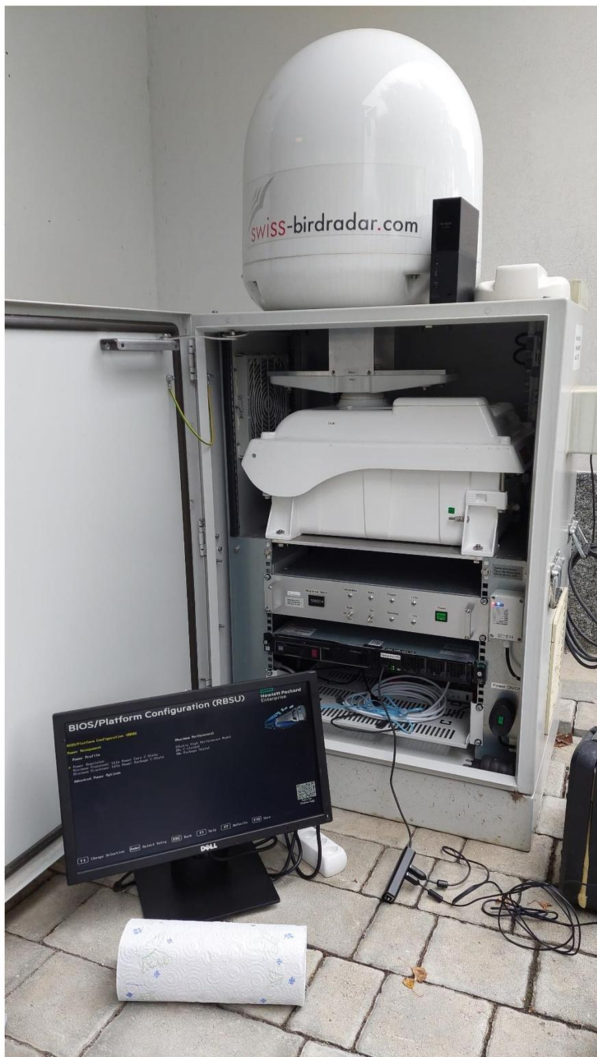
Figura 5 – Interno del radar BirdScan MR1 durante l'aggiornamento periodo del software e la sostituzione del magnetron. Dall'alto verso il basso si osservano, rispettivamente, il radome che include l'antenna, il radar, il controller del radar, il server e i dischi fissi per l'archiviazione dei dati. Alla destra del controller del radar è presente una SMS box per il controllo da remoto del radar.
