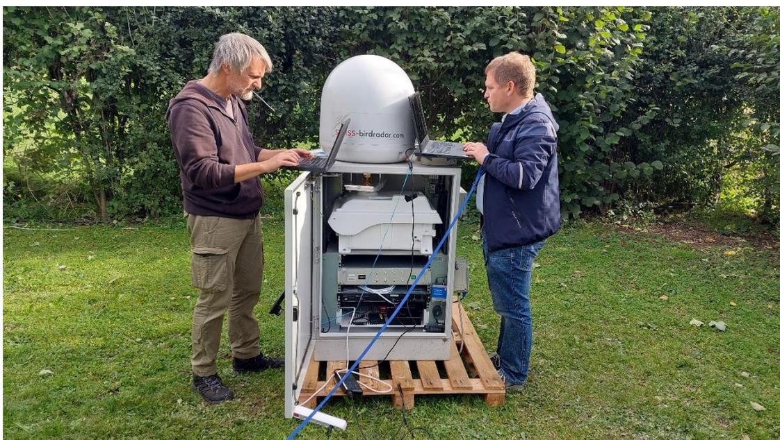
*Figura 3 – Attività di scarico dati periodico del radar BirdScan MR1 con i tecnici della SwissBirdRadar*
