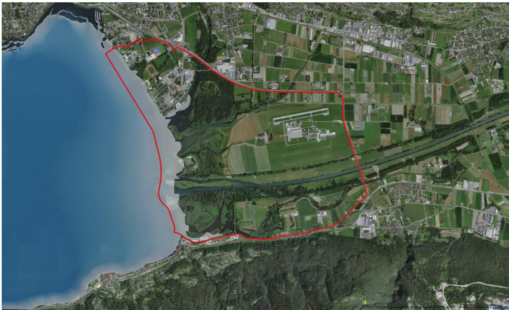
Figura 11 - Superficie allagata calcolata dalle simulazioni 3D corrispondente ad un livello del lago basso, ovvero di 192,5 m s.l.m. Come sfondo la foto aerea fornita da Microsoft® Bing™ Maps Platform
