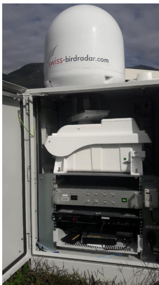
Figura 7 – Interno del radar BirdScan MR1. Dall'alto verso il basso si osservano, rispettivamente, il radome che include l'antenna, il radar, il controller del radar, il server e i dischi fissi per l'archiviazione dei dati. Alla destra del controller del radar è presente una SMS box per il controllo da remoto del radar.
