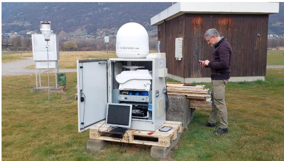
Figura 6 – Attività di manutenzione e scarico dati periodico del radar BirdScan MR1.
