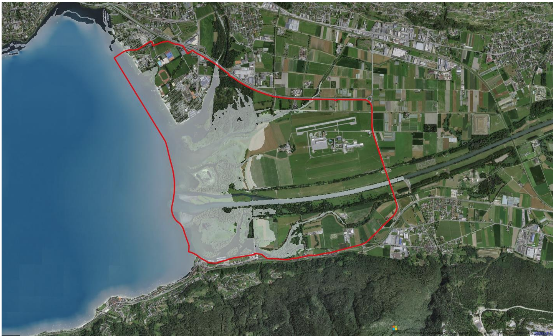
Figura 12 - Superficie allagata dalle simulazioni 3D corrispondente ad un livello del lago tra i più elevati, ovvero di 194,9 m s.l.m. Come sfondo la foto aerea fornita da Microsoft® Bing™ Maps Platform
