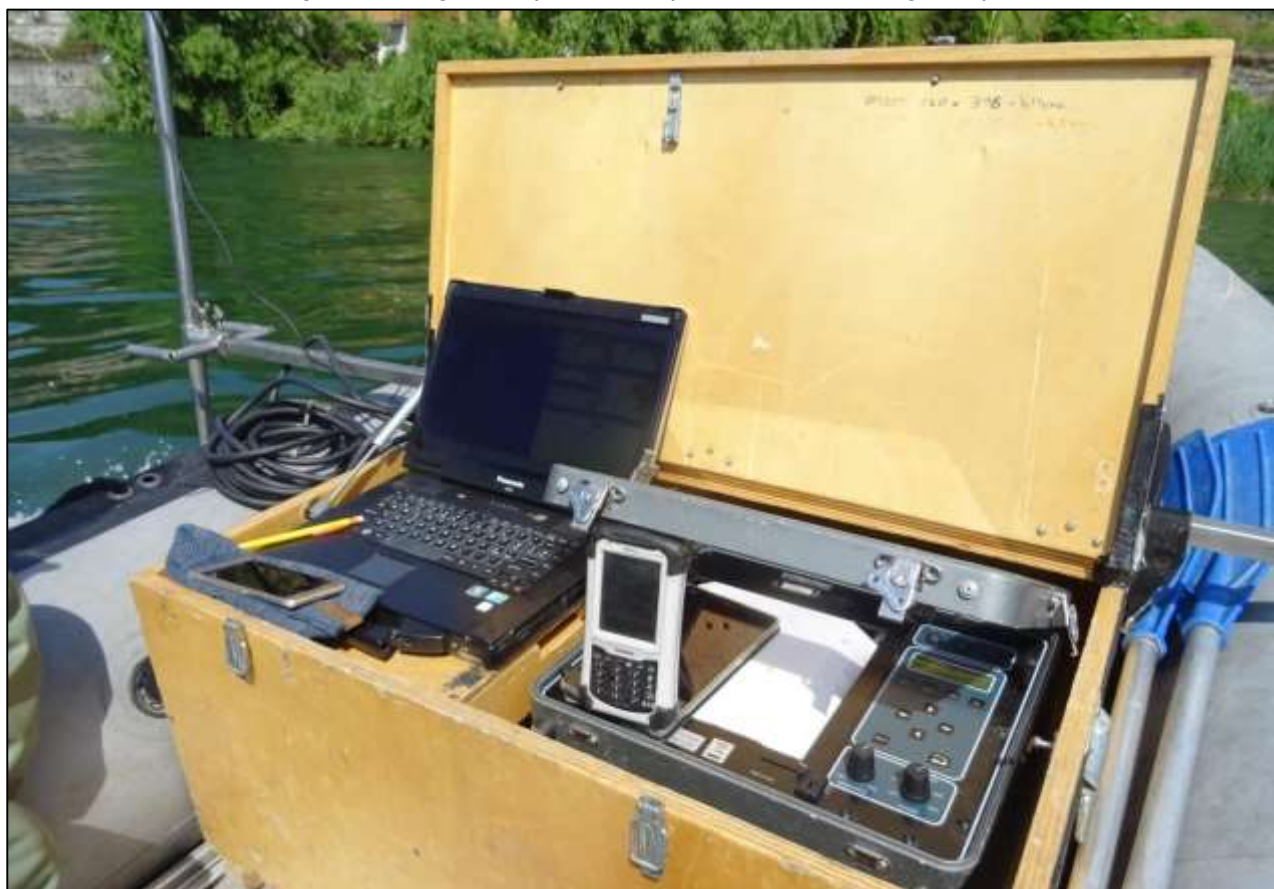
Figura 3-4: strumentazione utilizzata per il rilievo batimetrico sul lago di Mezzola
