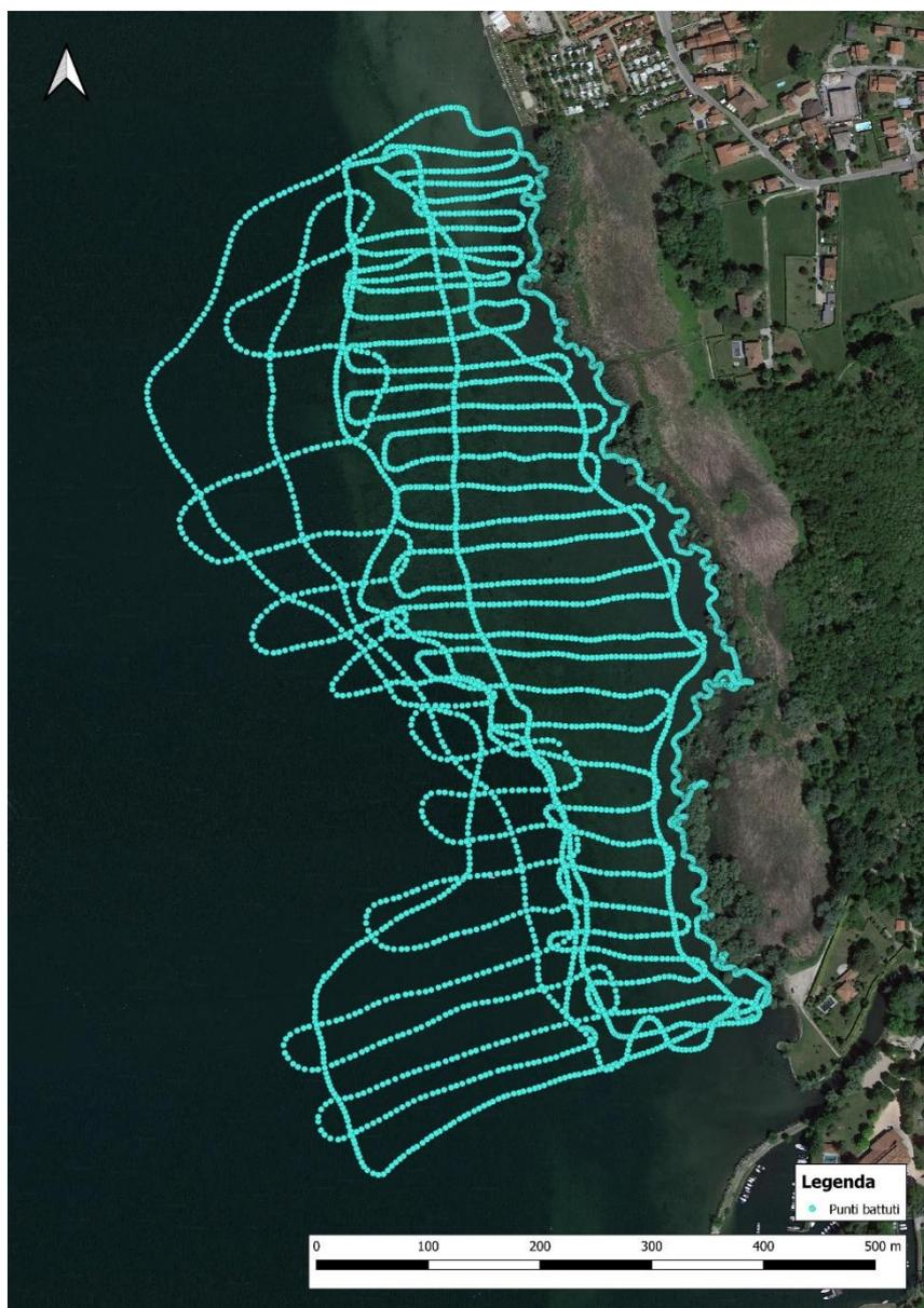
FIGURA 9 – RILIEVO BATIMETRICO NELL'AREA DI MONVALLE NORD
