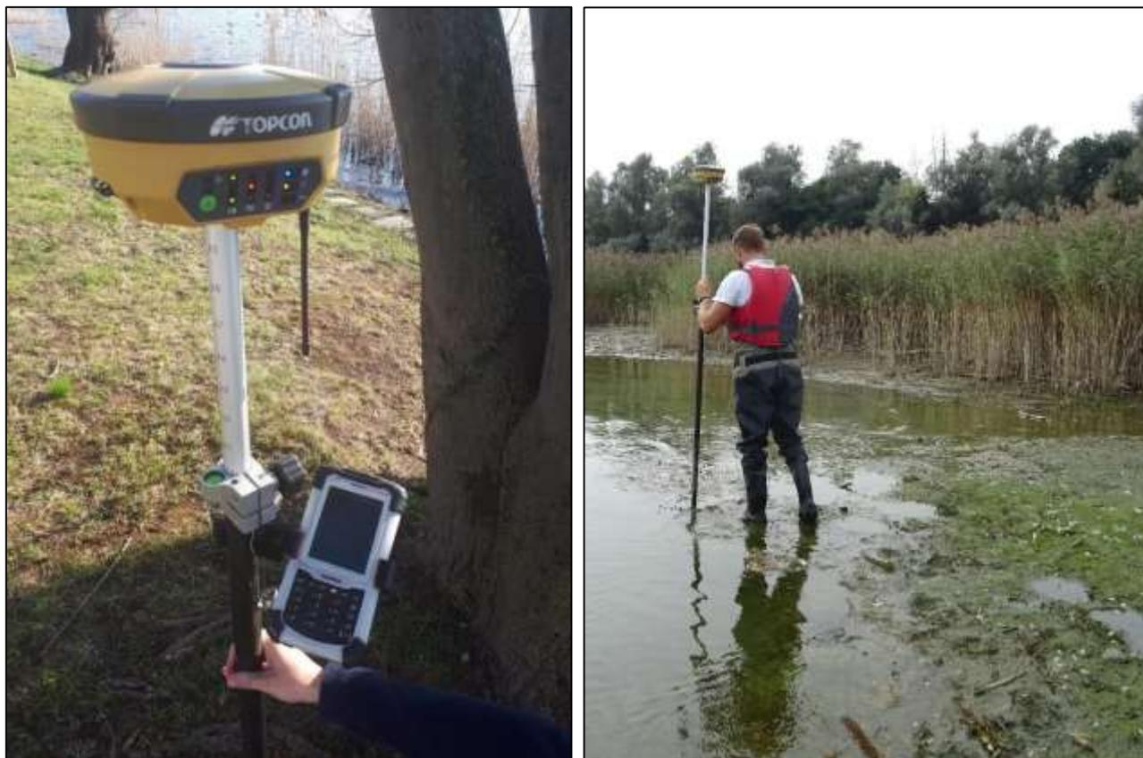
Figura 3. Strumentazione GPS utilizzata nei rilievi topografici
